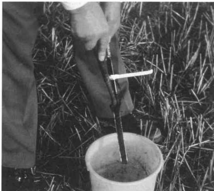
Mit dem Bohrstock werden Einzelproben genommen, in einem Eimer gesammelt und zu einer Mischprobe vereinigt.
